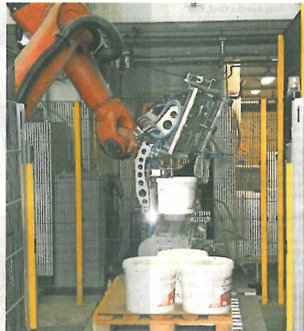
Dieser Roboter setzt die abgefüllten Farbeimer zielgenau auf Paletten. Haering wird sich demnächst einen zweiten Roboter anschaffen. Fotos: Haering/Jürgen Paul
